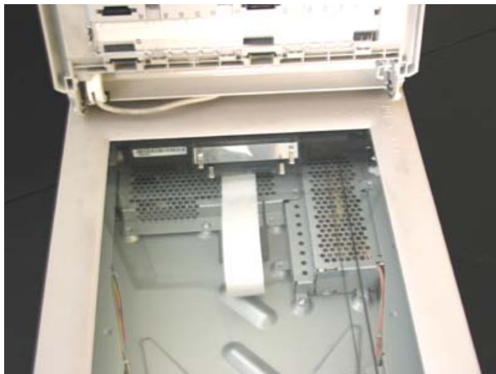
Un particolare del piano di scansione, si nota la lampada posta in alto collegata con un cavo Flat
