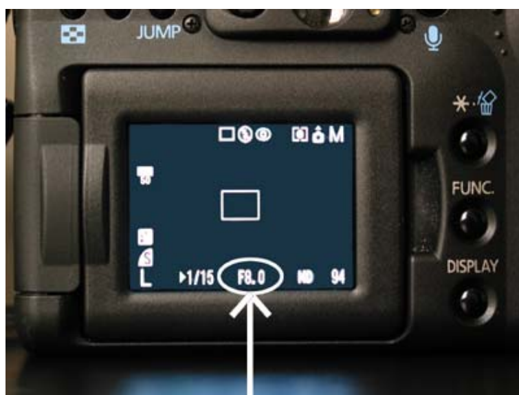
Il display di una fotocamera con evidenziato il diaframma (apertura 8 ossia apertura minima del diaframma)
