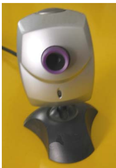
Una webcam, si può notare il dispositivo di messa a fuoco manuale
