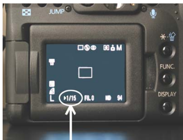
Il display di una fotocamera con evidenziato il tempo di esposizione (1/15 di secondo)
